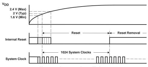
Figure 19. Power-On Reset Timing
